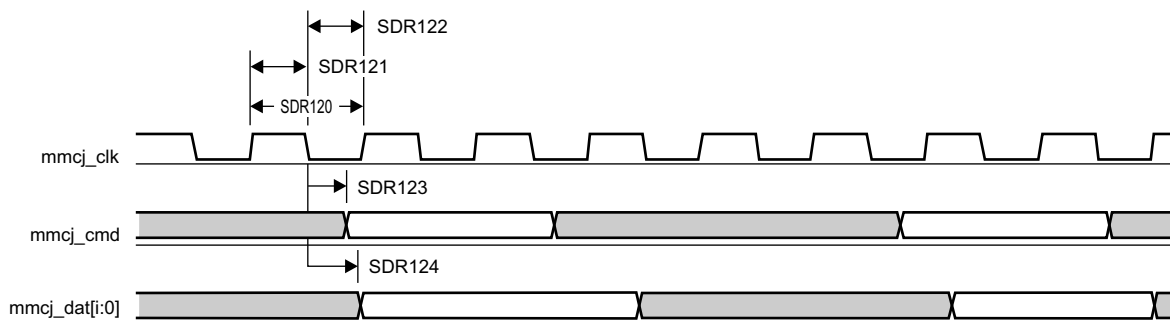
图 7-86. MMC/SD/SDIOj in - SDR12 - Transmitter Mode
