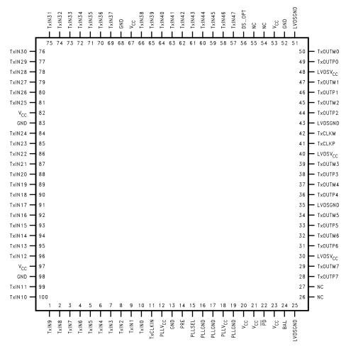
Figure 17. Transmitter - DS90CR481 - TQFP - Top View
