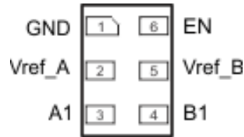
图 5-1. LSF0101 DRY 封装，6 引脚 SON（透明顶视图）
