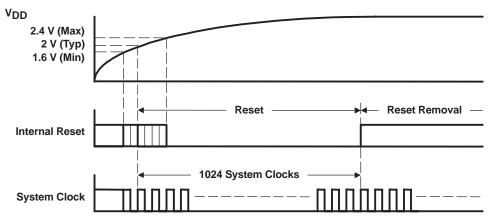
Figure 25. Power-On Reset Timing
