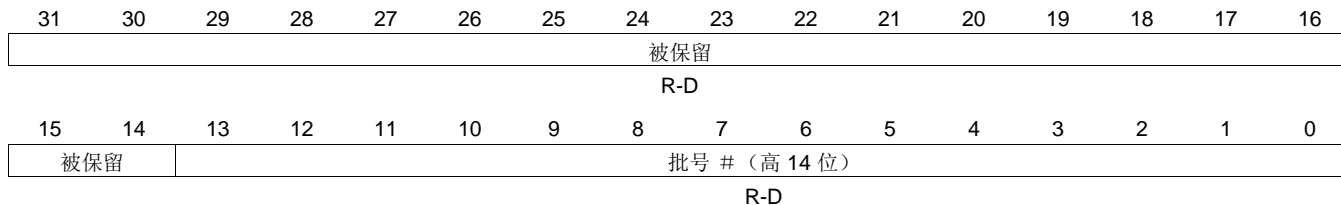
图 5-3. DIEIDH 寄存器 (地址: 0xFFFF FF80)
