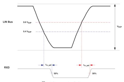
图 8-2. Propagation Delay
