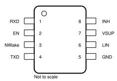
图 7-1. D Package, 8-Pin SOIC (Top View)
