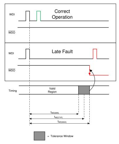
图 6-2. Watchdog Timing Diagram
