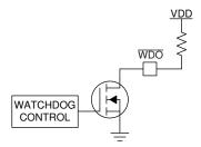
图 8-3. WDO Open-Drain Configuration
