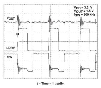
Figure 19. TPS40020 I<sub>ZERO</sub> Detection – DCM
