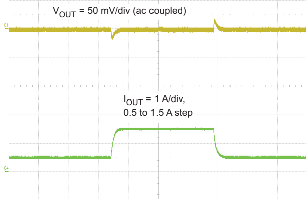
Time = 2 ms/div 1-A Load Step
