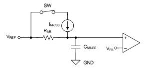
图 40. Simplified Soft-Start Circuit
