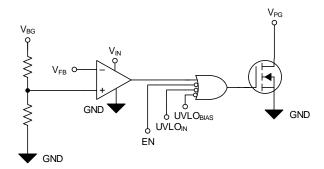
图 42. Simplified PG Circuit
