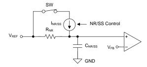
图 36. Simplified Soft-Start Circuit
