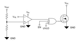
图 37. Simplified PG Circuit
