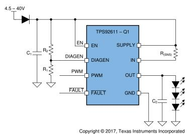
图 19. Typical Application Diagram
