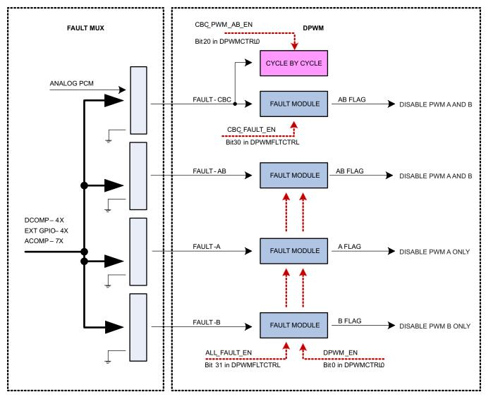
Figure 20. Fault Mux Module
